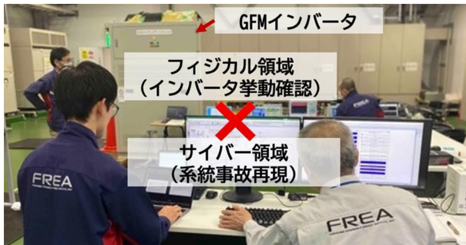
HILテストベッドの例 (GFMインバータをPHIL試験する様子)
