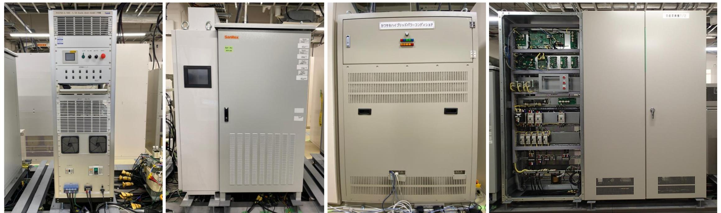
JET試験で系統電圧・周波数・位相が変化する試験項目を実施した。
